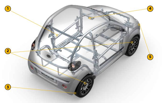
Microcar Türrahmen ist mit einem extra stabilen Aluminiumträger ausgestattet der quer verbaut ist und so einen erheblichen Beitrag zur Stabilisierung der Fahrgastzelle beiträgt.
